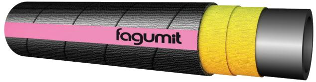
• elastyczny wąż stosowany w instalacjach samochodowych do przepływu paliw ropopochodnych o zawartości węglowodorów aromatycznych do 50%, w tym również bioetanolu (związków tlenowych do max 15%) oraz biodiesla (80% oleju napędowego i 20% biokomponentów - estrów) • temp. pracy: od -30°C do +100°C, okresowo +125°C • warstwa wew.: gumowa, NBR, czarna, gładka • wzmacnienie: tekstylne • warstwa zew.: gumowa, NBR/PVC, czarna, odporna na czynniki atmosferyczne i wysoką temperaturę
