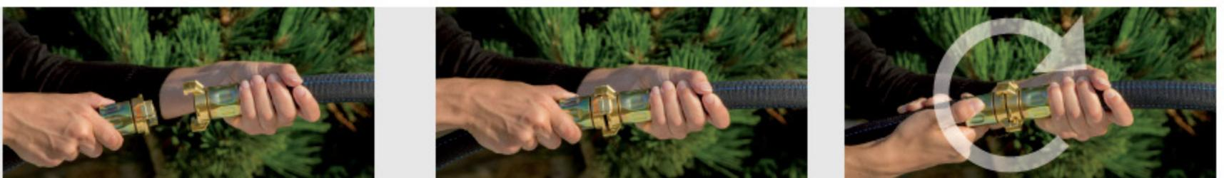
Zum Entkuppeln einfach die Kupplung und das Gegenstück in Axialrichtung zusammendrücken. Abschließend eine Kupplungshälfte in entgegengesetzter Richtung zum Kuppeln bis Anschlag drehen und vom Gegenstück abziehen.
